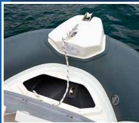
Na stopi za ulaz je sidreni rodul i kaštanjola za vezivanje
