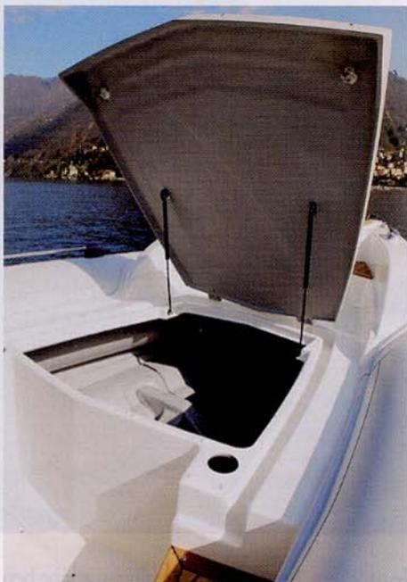
*Il vertice di prua è organizzato con verricello, portello di copertura per lo sbarco, passacavi e galloce ben fissate su un elemento strutturale e non solo incollato. Curato il drenaggio del calpestio. Il gavone di prua sfrutta l'altezza del ponte per offrire un volume di stivaggio eccezionale.*
