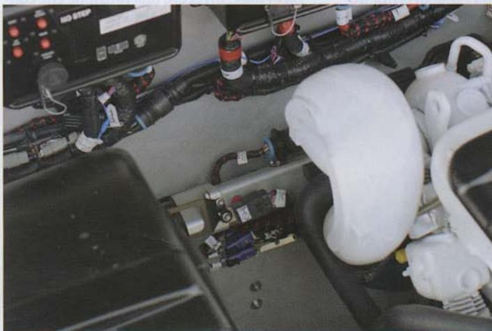
*In alto: le due centraline che governano il sistema Axius. Non è nulla di complicato: di fatto, grazie all'elettronica, è possibile trasformare l'impulso del joystick in «ordini» per i propulsori e i piedi. A destra, le pompe idrauliche che agiscono come invertitori sulle trasmissioni. A sinistra: uno dei due pistoni appositamente realizzati per l'Axius.*
