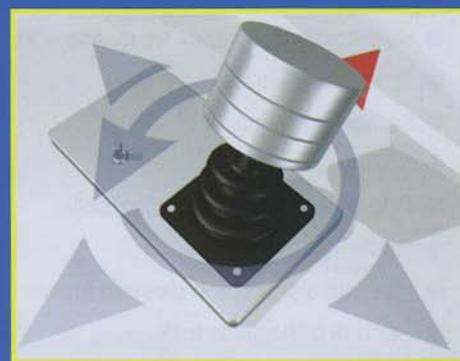
*Il «magico» joystick attraverso il quale si comanda l'Axis. È la prima volta che viene applicato su un rib in abbinamento a due diesel CMD da 320 hp. Nelle due sequenze in alto, abbiamo voluto saggiare le qualità di questo sistema, che agisce su due classici piedi Bravo 3. Nella prima «striscia» l'accosto alla banchina effettuato semplicemente spostando il pomello a destra. Nel secondo abbiamo simulato la rotazione su se stesso. Noteate che la distanza dal pontile resta sempre la medesima.*
