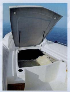
pozzetto interno; in questo modo viene aumentata la lunghezza del prendisole mantenendo sgombra una buona porzione del pa-gliolato proprio davanti alla panca anteriore, per offrire spazio alle gambe di chi siede. Secondo uno stile tipico della gamma, tutte le stive sono accessibili attraverso aperture di grandi dimensioni che permettono di calarsi all'interno dei gavoni per meglio ordinarne
