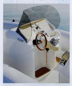
La plancia offre molto spazio per le strumentazioni di navigazione: a richiesta è disponibile un «pack elettronico» comprendente il Gps + Eco con schermo da 8", il Vhf e lo stereo Clarion, tutti installati dal cantiere. Perfetta la posizione dei comandi del motore, sistemati su un'isola centrale. Manca un corrimano attorno al parabrezza.
