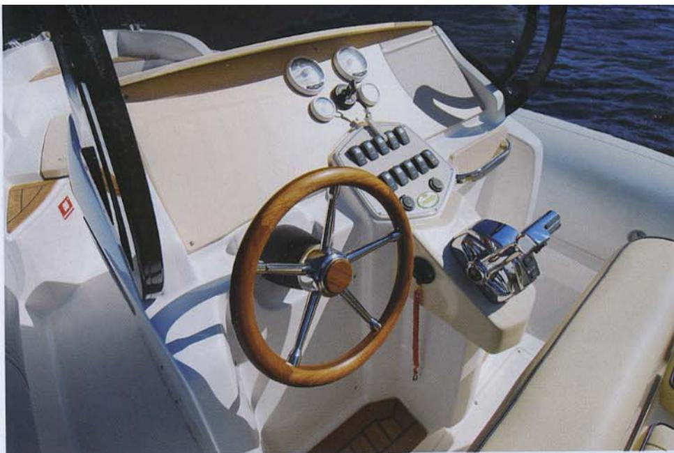
che se un ulteriore pannello, possibilmente imbottito, andrebbe previsto per coprire il retro degli strumenti e scongiurare il pericolo di testate, dato che l'altezza interna è di soli 135 centimetri. Allo stesso modo, il bordo della porta - sebbene perfettamente levigato - andrebbe guarnito con un profilo di gomma che attenuerebbe eventuali urti.
