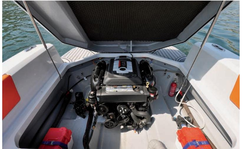
*Il 4.5L è il primo monoblocco entrofuoribordo interamente realizzato in casa da Mercury e appositamente progettato per l'impiego nautico. La distribuzione prevede due valvole per cilindro (senza fasatura variabile) per semplificare al massimo l'architettura e contenere, anche in questo modo, il peso. L'alimentazione è a iniezione indiretta multipoint.*
