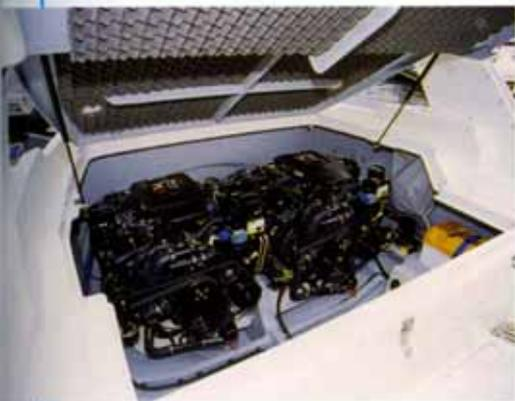
**I due Mercruiser a benzina 4.3L MPI sono sistemati molto vicini. Il portello è provvisto di due attuatori che ne facilitano l'apertura.**
