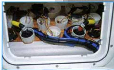
ribaltamento completo del sedile antistante il cassero. Il vano è rifinito in modo impeccabile: i cavi di comando dei motori e quelli elettrici degli strumenti transitano in spazi appositi e non sono in vista. Un solo difetto: l'oblò che si apre dalla cabina verso la postazione di guida ha un profilo un po' affilato che potrebbe essere urtato con le ginocchia.
