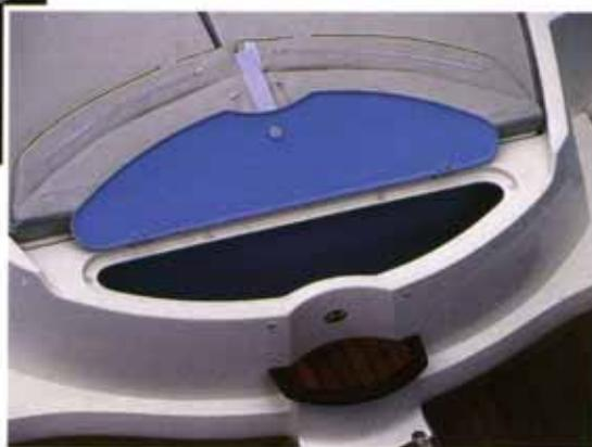
sui battelli con occhio di cubia sotto al tubolare). L'estremità di prua è facilmente sostituibile in caso di danno.
