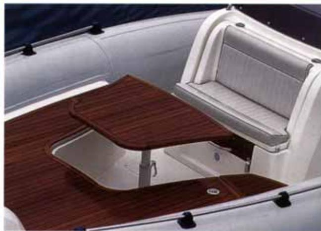
Il tavolo di prua in teak, sollevabile manualmente, forma un grande piano prendisole. Il portello del gavone è realizzato in un pezzo unico, ma l'apertura è facilitata da due attuatori idraulici.
