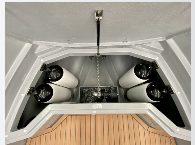
Il Musone di prua è dotato di passacima e bitte per ormeggio Seasmart a scomparsa, verricello elettrico con telecomando, ancora Ultramarine 12KG in acciaio inox, gavone per catena, cime e parabordi
